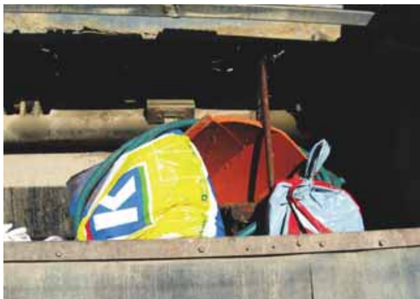
Jätteenkuljettaja näkee parhaiten, minkälaista jätettä ihmiset panevat jäteastiansa. Muoviletku, muovisen ruukun osat ja rauta tukkivat kuljetushihnaa Pirilön lajittelulaitoksella ja rikkovat lajittelurobotit. Myös jäteauton hydraulikka voi rikkoutua.
