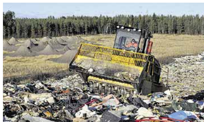
På deponeringsfältet kan man se kompaktorn i arbete. Deponiavfallet pressas ihop och täcks av ett skyddslager. På så vis blåser inget avfall ut i omgivningen, inga skadedjur kan bygga bon där och brandsäkerheten ökar. Dessutom ökar man volymen på deponin när man pressar ihop avfallet.
